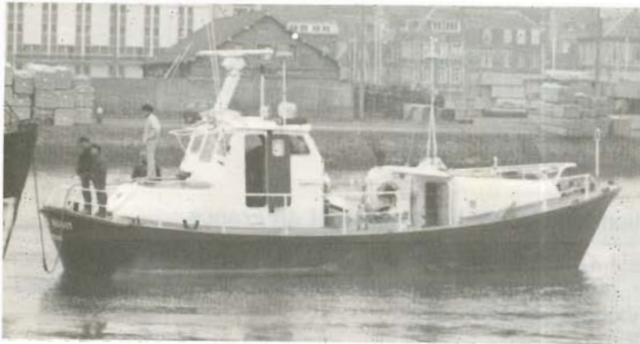
Construction acier auto-redressant montée par un équipage de 7 hommes en opération à l'année longue.
