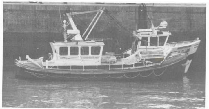
Canot de classe I de type ancien. Construction bois 2 moteurs. Monté par une équipe de sept hommes.
